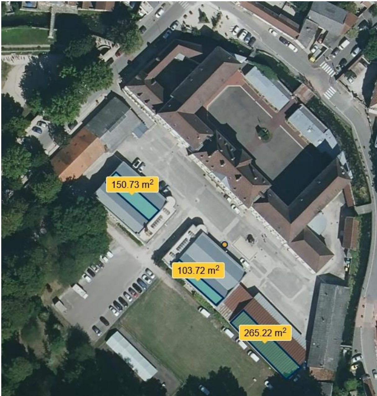
VUE AERIENNE 4 : POTENTIEL SOLAIRE, CRS 40 = 765 m 2
